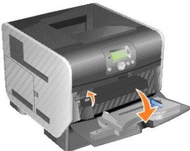
3. Allineare le linguette dell'alimentatore buste agli alloggiamenti ai lati della stampante, quindi inserire delicatamente l'alimentatore nell'apertura finché non *scatta* in posizione.
