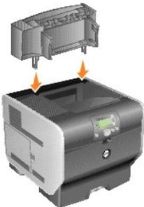
4. Se si installa l'espansione di uscita sulla stampante o su un'altra espansione di uscita, collegare il sostegno metallico. Inserire le linguette del sostegno metallico nelle estremità della staffa di plastica in modo che il sostegno si pieghi verso il basso.
