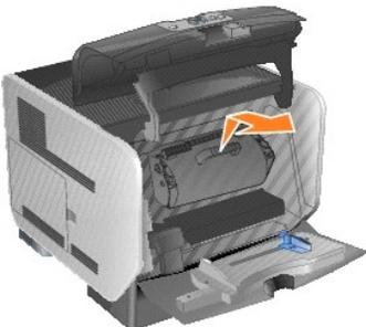
5. Individuare il rullo di trasferimento da sostituire sulla parte inferiore nell'interno della stampante.
